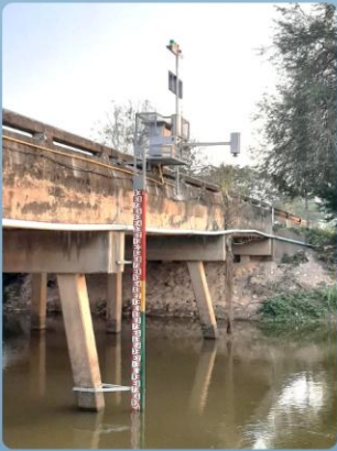
สถานีเตือนภัยด้วย ปริมาณน้ำฝนและระดับน้ำ
